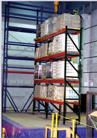
Simularea începe, raftul se clatină, încărcătura începe să se miște.
