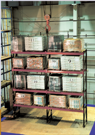
Cu izolarea bazei Pellegrino, structura raftului continuă să funcționeze fără probleme.
