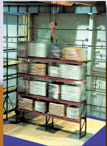
Toată marfa rămâne intactă pe rafturi în timpul celei mai severe simulări de cutremur și structura nu prezintă nicio defecțiune!
